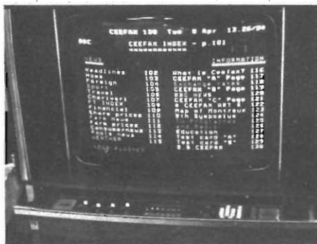
Fig. 7 - Un ricevitore televisivo provvisto del decodificatore Tifax per la rappresentazione Teletext della CEEFAX (più chiaro di così...!).
