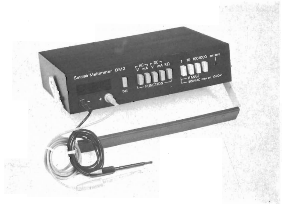
Fig. 1 - Aspetto frontale del nuovo multimetro digitale Sinclair modello DM2. I pulsanti per la scelta della portata e della funzione sono stati differenziati nel colore per rendere ancora più facile e razionale l'uso del dispositivo.
