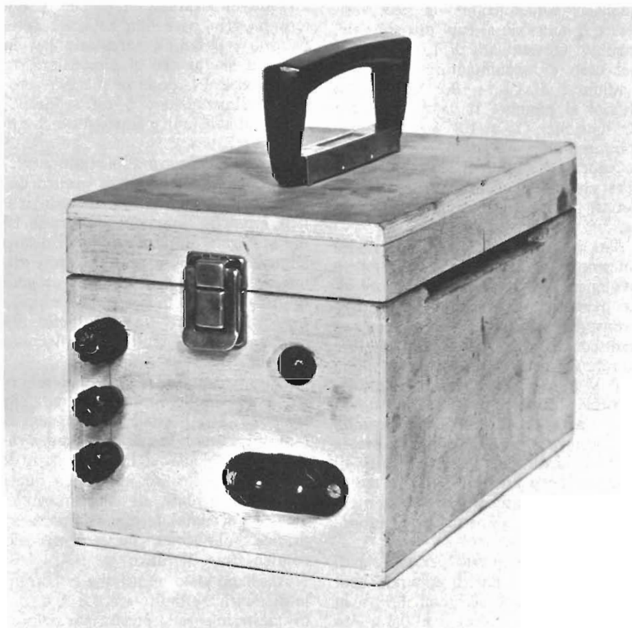
Fig. 1 - Un alimentatore in c.c. da 12 Volt per alimentazione di ricetrasmittitori da amatore ed in genere di radioappartori.
